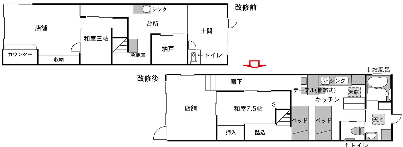
兵庫区に位置するN邸は、古いクリーニング屋さんでした。若かりし頃使っていたクリーニング用の機械も今は使わずに土間に放置されたままの状態。居住部分はせまく、掃除に手がまわらない状況でした。息子さん夫婦の同居を機会に住宅改修助成制度を利用して改修工事をすることに。居住部分を広くし、万一車椅子を使用することになっても介護をしやすいように、トイレ・浴室を三枚の引き戸にする、車椅子でも自分で移動できるように居室の配置を替える、安全性を考えてオール電化にするなど、様々な工夫をこらした事例です。
